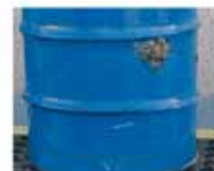
Obrisati površinu i začepiti rupu
