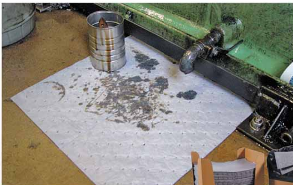
MRO upijači ispod nehermetičnih brtvljenja i ventila/slavina
